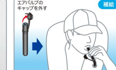
気室の膨らみが十分でない時、エアバルブキャップを外し息を吹き込み補給します
