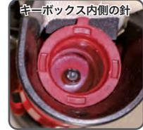
**注意** 使用済カートリッジポンペを外した際、キーボックス内側の針に損傷が無いか確認してください。針に損傷がある場合は、取扱店にご相談ください。針が損傷した場合、エアバッグは作動しません。
