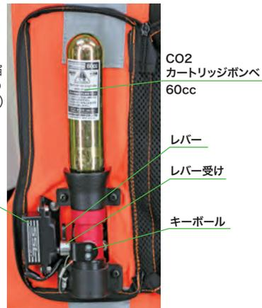
エアバッグは、一定の衝撃を受けた際に、センサーが感知しキーボックスのサーボモータがキーボールを押し上げて作動します。
