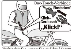
Verbinden Sie, wenn Sie auf das Motorrad steigen, die Hit-Air-Airbagweste mit dem „One-touch-Verbinder“ (Stecker).
