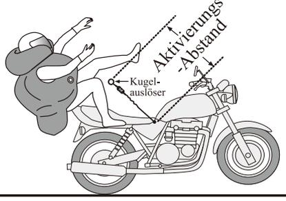
Die Hit-Air-Airbagweste (ein den Aufprall abfederndes Schutzsystem) wird als Oberbekleidung während des Motorradfahrens getragen.
