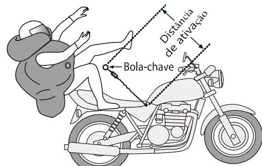
Se o cabo de conexão durante o seu arranque encontrar um obstáculo (por exemplo o corpo do piloto ou qualquer outra parte do veículo), é possível que o sistema se ative antes da distância de ativação ser atingida.
