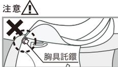
胸具託環へ伸縮ワイヤーを直接取付けるのはおやめ下さい。胸具託環(サドルホルダー取付け用具)へ伸縮ワイヤーを直接取付けると作動の際に金具が破損したり、根元からはずれて作動しない場合があります。
