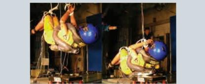
エアバッグジャケット装着と非装着の人体模型を背面から落下させ、胴体への加速度の違いを測定しました。実験は人体模型を衝突台へ落下させ、落ちた衝撃を加速度センサーで測定、G値が小さいほど衝撃が緩和されます。
