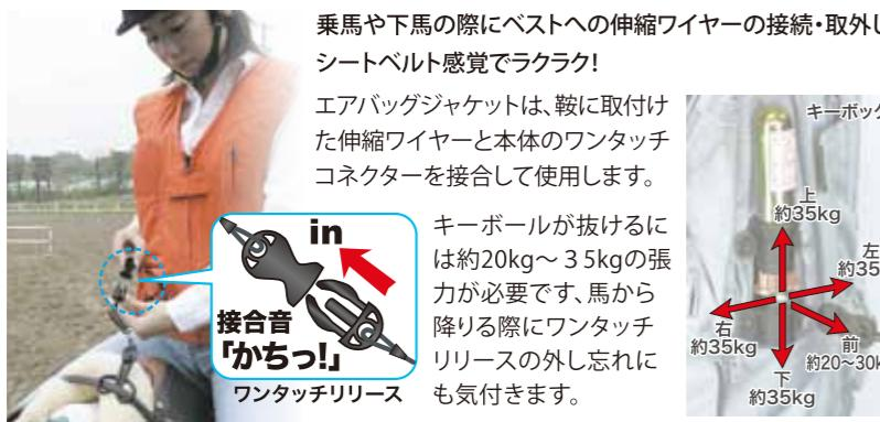
乗馬や下馬の際にベストへの伸縮ワイヤーの接続・取外しもシートベルト感覚でラクラク!
